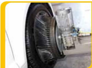
La inversión de rotación e inclinación del cepillo permite una apurada limpieza de las llantas de varias dimensiones.
