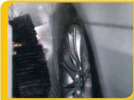
Lava-ruedas inclinable con alta presión rotante integrada para una apurada limpieza de llantas, pasos de ruedas y partes laterales.
